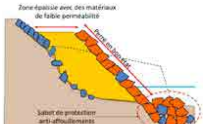
Schéma en coupe des digues avant/après les travaux réalisés par le SISARC
