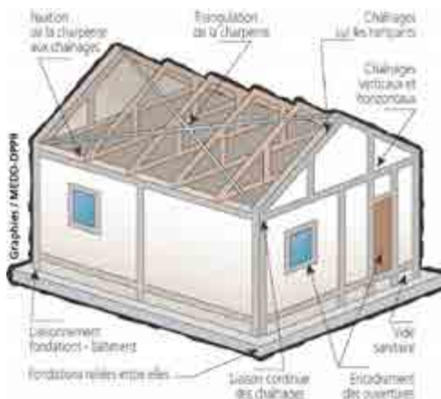
Schéma de construction parasismique
