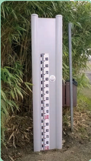
Échelle limnimétrique située à proximité du port permet d'avertir la population.
