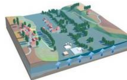
inondation de nappe
