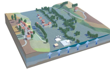
inondation de nappe
