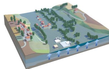
inondation de nappe
