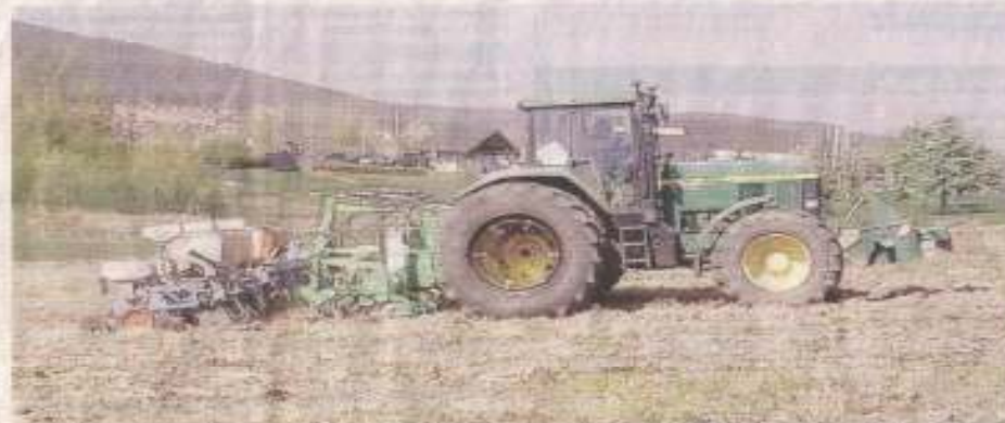
La nouvelle machine, le « strip till », griffe le sol et sème en un passage. Ce qui permet de semer sans labourer. (Photo DRV)
