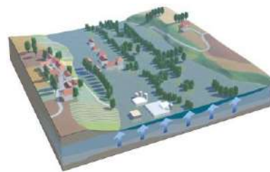
Inondation de nappe
