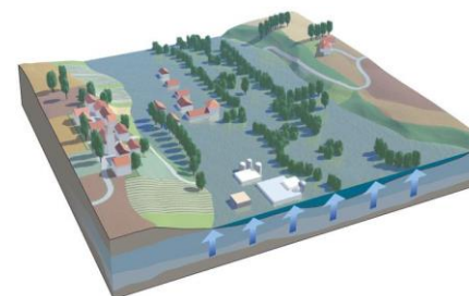
inondation de nappe
