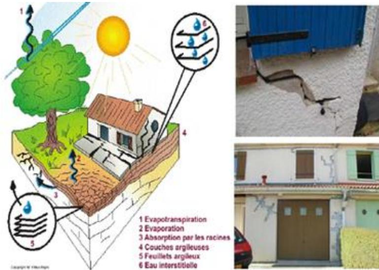
Mécanismes et conséquences des tassements différentiels par retrait-gonflement des sols argiles glissements de terrain :
