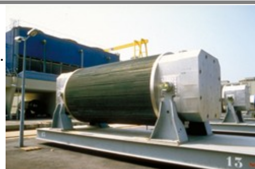
Colis de transport de combustibles irradiés
