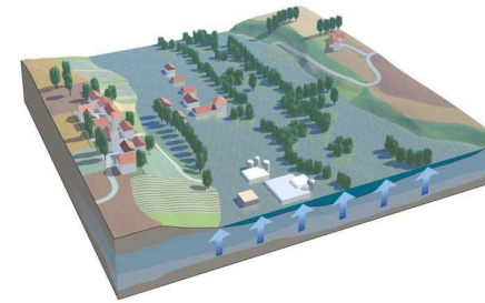
inondation de nappe
