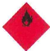
Liquide ou Solide présentant des émanations de gaz inflammable au contact de l'eau
