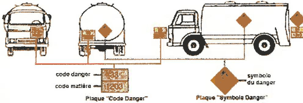
plaqué "code danger" à l'avant et à l'arrière du camion, et sur les côtés et à l'arrière de la cuve.
